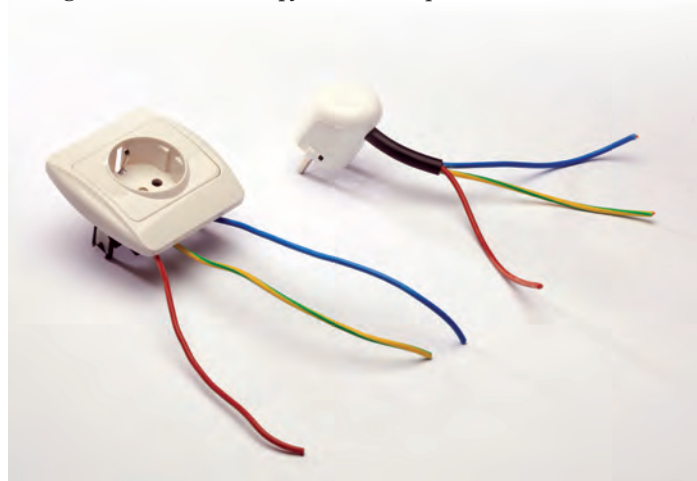
Védőföldelés vezetékei konnektorban és villásdugóban (középső, sárga-zöld vezeték)
