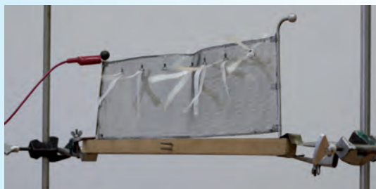
Papírelektroszkópokkal vizsgáljuk a töltések elhelyezkedését a fémhálón
