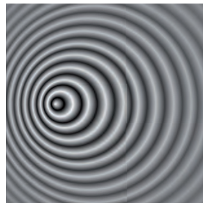
Hullámkádban mozgó hullámforrás által keltett hullámok
