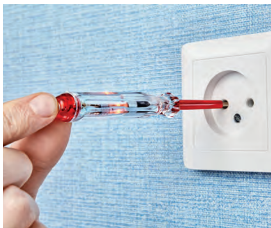
Fázisceruzával megtalálhatjuk a fázisvezetékét
