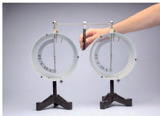
Mindkét elektroszkópon kiegyenlítődnek a töltések
