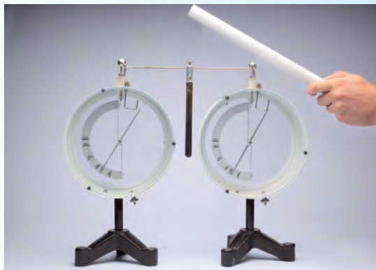
Az elektroszkópok lemezkéinek kitérése a töltött test közelítésekor növekszik
