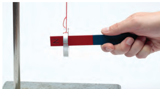
Elektromágneses indukciós kísérlet nyílt karikával
