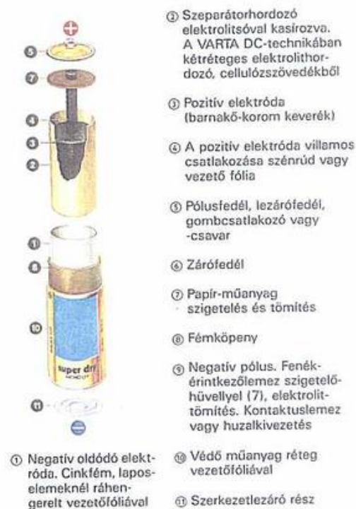
4. Leclanché Leakproof 1 , szivárgásmentes cella acélköpenyben
