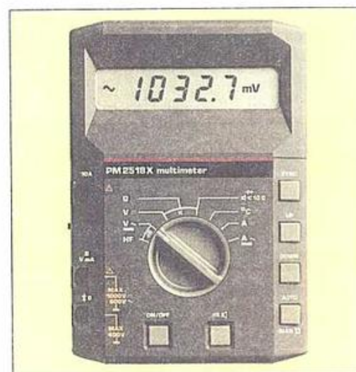
2. Digitális kijelzésű univerzális műszer
