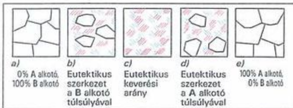
1. Eutektikus ötvözet kristályszerkezetének vázlatos ábrázolása
