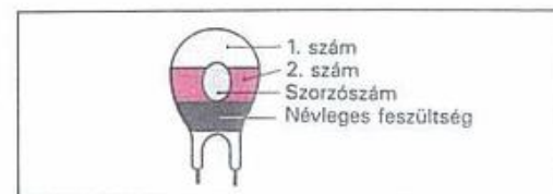
2b. Tantál elektrolitkondenzátor
