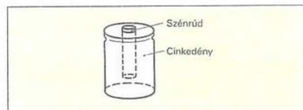
2. A cink alkalmazási példája: a szén-cink elem
