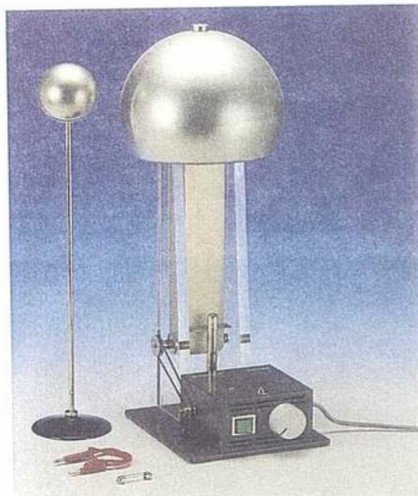
4. Szalaggenerátor. Töltések szétválasztása súrlódási erővel
